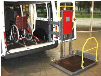
Fot. 6.33. Ford Transit przystosowany do przewożenia osób niepełnosprawnych na wózkach inwalidzkich (Źródło: materiał reklamowy Firmy Dom Samochodowy GERMAZ Sp. z o.o. Wrocław)
