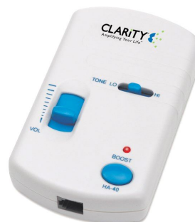
Fot. 6.50. Wzmacniacz do słuchawki telefonicznej dla niedosłyszących – model EHA40 Clarity firmy PLANTRONOCES (Źródło: materiał reklamowy firmy)
