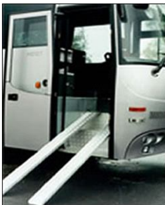
Fot. 6.35–6.36. Autobus przystosowany do przewozu osób niepełnosprawnych wyposażony jest w miejsca do kotwiczenia wózków oraz podest do wprowadzania wózka (Źródło: www.autosan.pl )
